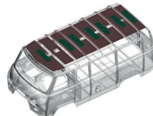
Иглопробивной материал обивки крыши
